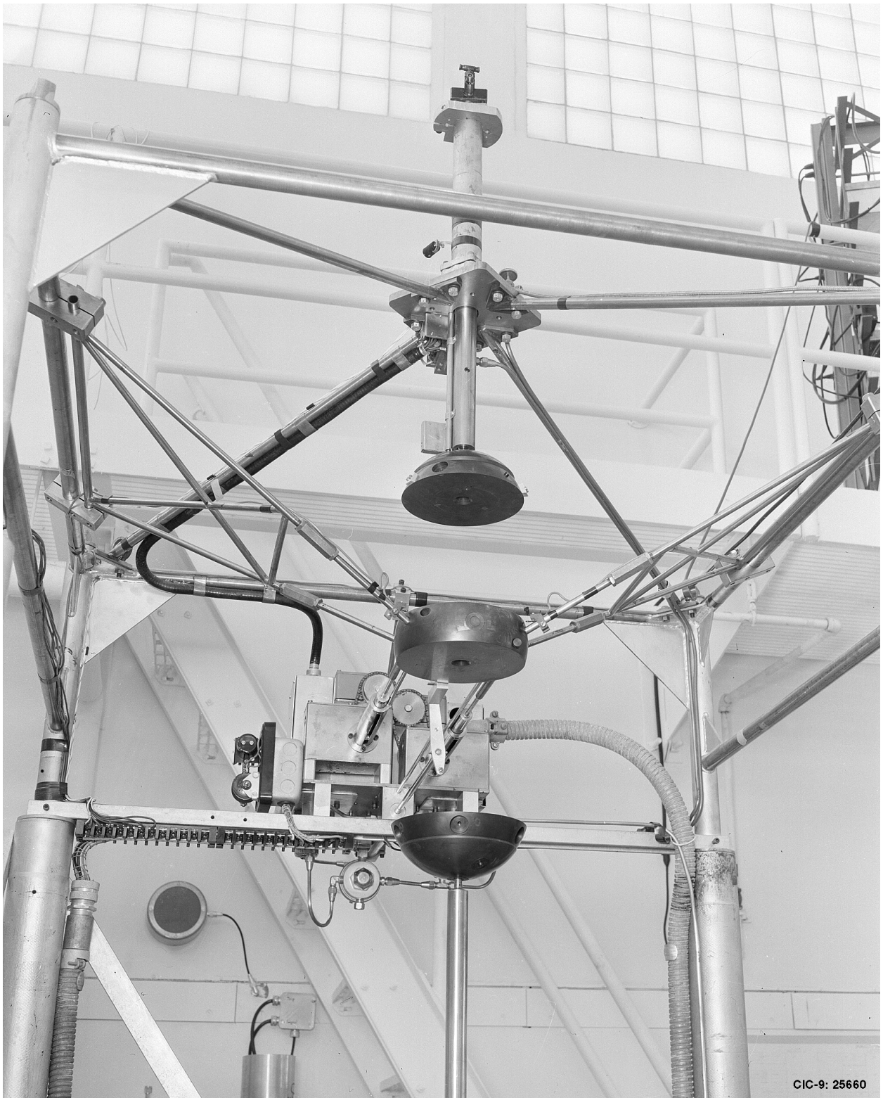
Рисунок 48. Критсборка «Леди Годива» в Лос-Аламосской национальной лаборатории (сфера из обогащенного урана без отражателя) в заглушенном состоянии.
