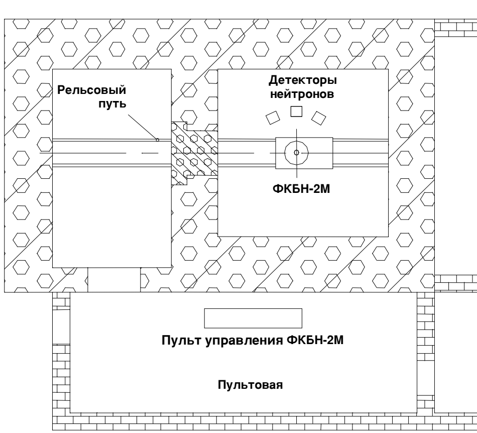
Рисунок 54. Планировка здания установки ФКБН-2М.
